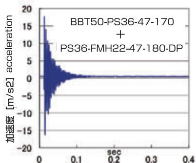
●切削条件: 立型MC ビッグプラスBBT50 被削材S50C
