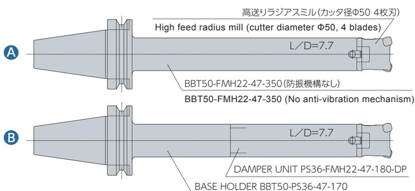
● 切削条件: 立型MC ビッグプラスBBT50 被削材S50C
