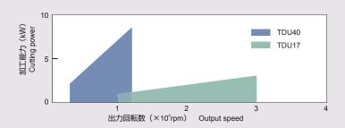
2 トルク伝達 Torque transmission characteristics
