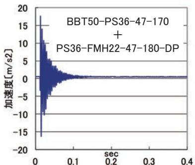
●切削条件: 立型MC ビッグプラスBBT50 被削材S50C
