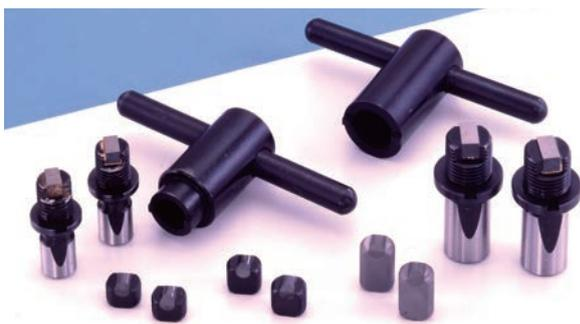
貫通穴加工の場合に加工径、機械の回転数及び送り、主軸の剛性など、切削条件によって、貫通直前に横振れすることがあり、切削刃を損傷・破損したりする場合があります。この場合、超硬ガイドを取付ると、振れを最小限に防ぎます。
